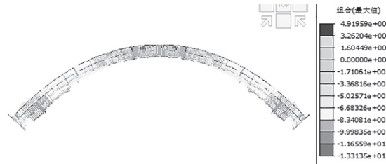
图 12 标准组合钢管内混凝土应力图 (单位:MPa)
