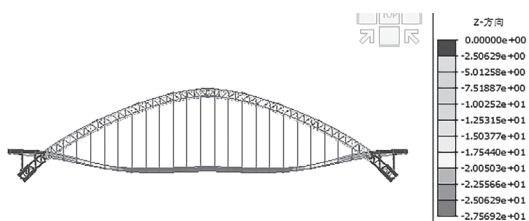
图 14 汽车作用下拱肋桥面系最大向下竖向挠度图 (单位 :mm)
