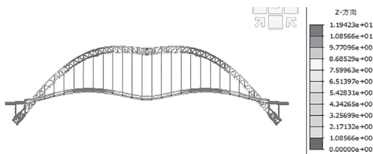
图 13 汽车作用下拱肋桥面系最大向上竖向挠度图 (单位 :mm)
